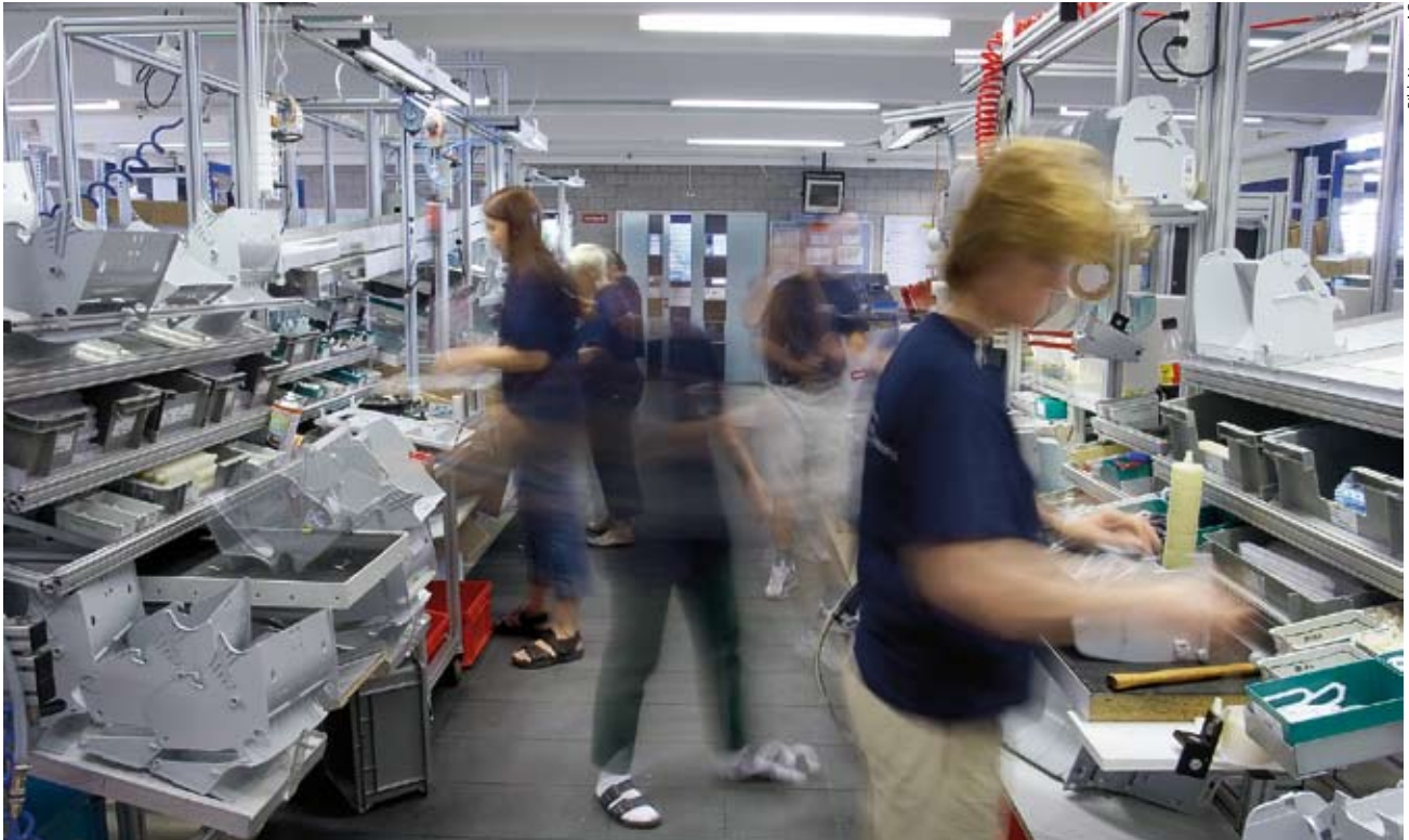
Das Einstückfluss-Prinzip der Noventa: Montage eines Handtuchspenders in einem Arbeitsprozess vom Einzelteil bis zum Endprodukt.
